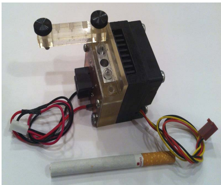
Figure 2. Mini PCR device
